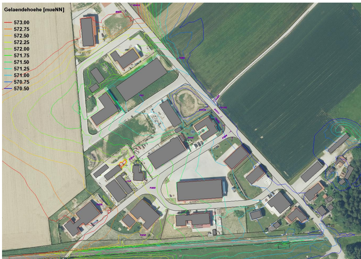
Abbildung 3.2: Geländehöhen und Gebäude im Abflussmodell (Bestand); Übersicht
